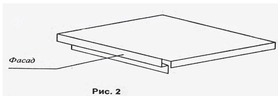
**Полки шкафа** на нижней поверхности имеют усилитель и два уголка, входящие при установке в захваты боковых стенок (рис.3).
