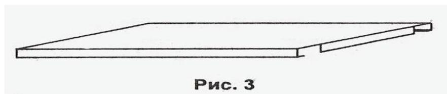
**Боковые стенки.** На фасадном торце расположены петли для навески дверей. В задней части стенки профиль образует «Г» образный паз, в который входят задние стенки. Для установки полок по всей высоте стенки расположены 2 ряда захватов (рис. 4).
